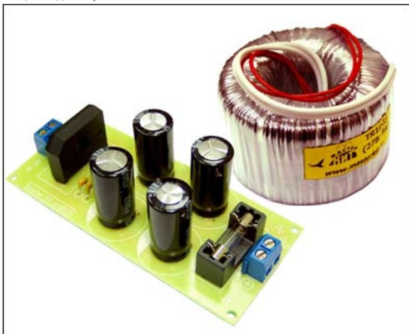
Предлагаемый набор позволит радиолюбителю собрать простой и надежный однополярный нестабилизированный сетевой источник питания, состоящий из силового тороидального трансформатора, блока выпрямителя с диодным мостом и фильтрующими емкостями.
